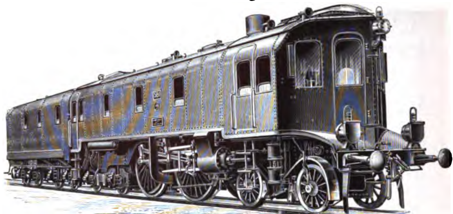
2/6 gekuppelte Vierzylinder-Verbund-Schnellzuglokomotive (150 km Geschwindigkeit in der Stunde).
